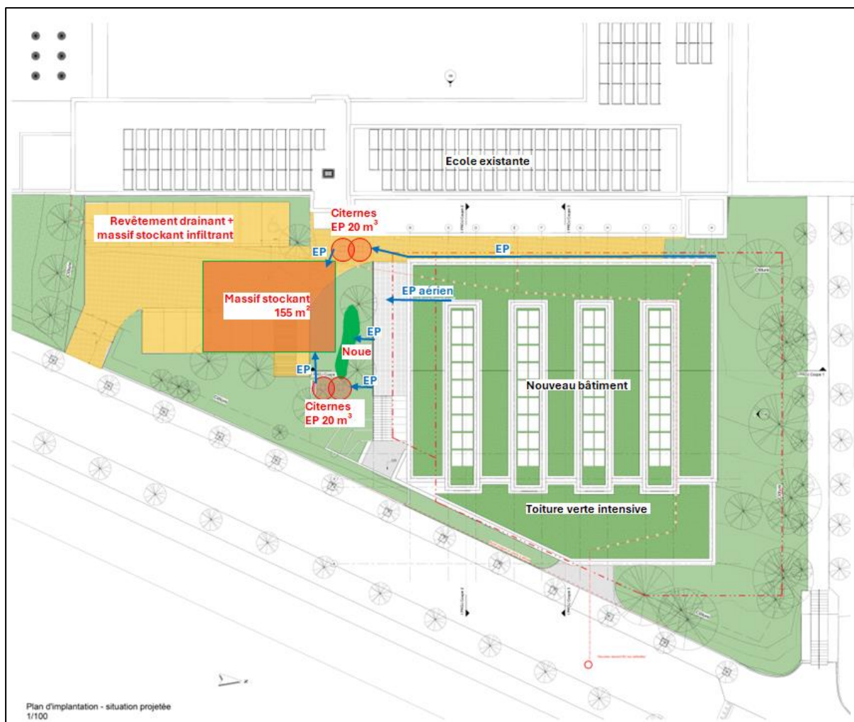
Figure 13 : Plan schématique de gestion des eaux de pluie – projet modifié
